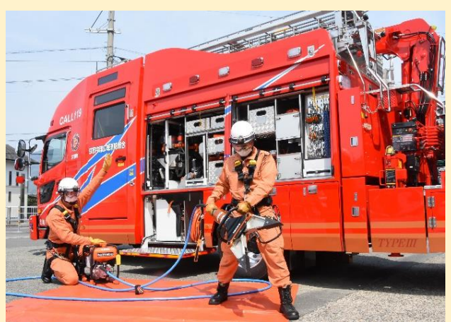
積載資機材（エンジンカッター、油圧器具）
