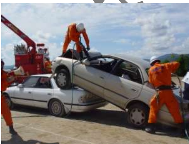
交通事故現場で油圧器具により、事故車両の天井部分を切断し、負傷者を救出中の救助隊
